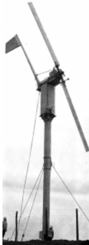
Aerogeneratore a due pale
