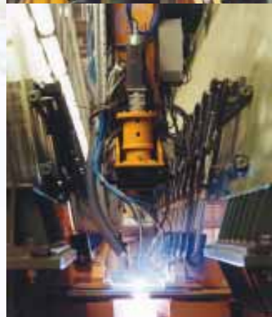
La Macchina per saldare realizzata per la Fincantieri di Monfalcone, la testa di focalizzazione del laser durante una saldatura ed il prototipo di laboratorio
