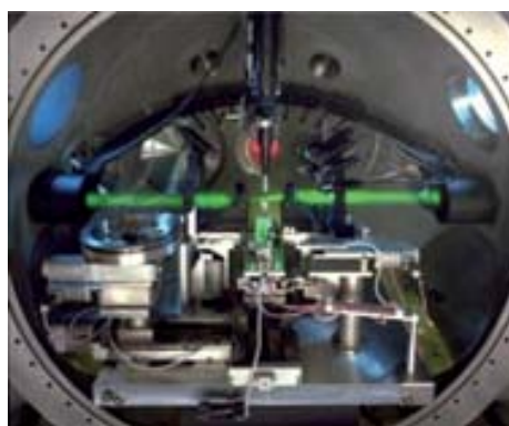
La camera di interazione del laboratorio ABC nella quale i fasci laser (colore verde) incidono sul bersaglio da direzioni opposte
